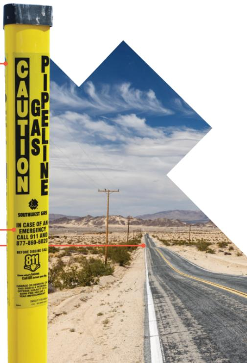
Las tuberías se encuentran en un espacio denominado derecho de paso (ROW, por sus siglas en inglés). Un ROW o derecho de paso de una tubería es una franja de terreno situada por encima y alrededor de la tubería. En este ámbito, el propietario cede algunos derechos legales al operador de la tubería para que pueda inspeccionar y mantener la tubería con el fin de garantizar un funcionamiento seguro.
